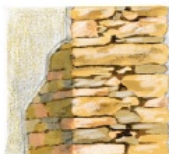
mur ancien souvent maçonné à la terre, enduit fin à la chaux (intérieur et extérieur)
