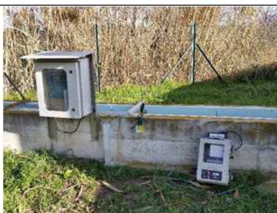
Contrôle-débitmètre-sortie-STEP-Pernes-Village
